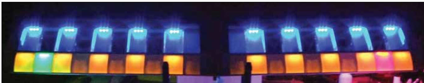
Top wing view of my Kadet Senior Night Flyer Project. There are 30 yellow LEDs spaced on the center front of the D-box sheer webbing, 6 red and 6 green LEDs on the left and right - 2nd bay in from the tip D-boxes, 6 red and 6 green LEDs on the left and right wing tips and 30 blue LEDs spaced just ahead of the ailerons, inside the wing. All LEDs will be inside and hidden, until turned on. / Un aperçu au-dessus des ailes du projet de Kadet Senior pour le vol de nuit. Une série de 30 diodes DEL de couleur jaune sont réparties à l'avant de la section en D; six diodes rouge et six diodes verts sont disposés à gauche et à droite (presqu'à l'extrémité des saumons d'aile); six diodes rouge et six diodes verts sont disposés sur les saumons et 30 diodes DEL bleu sont disposés juste à l'avant des ailerons, encastrés dans les ailes. Tous ces diodes seront placés à l'intérieur et cachés jusqu'à ce qu'ils soient mis en marche.
