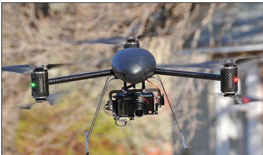
The Draganflyer X6 Helicopter with LX3 digital camera. / L'hélicoptère X6 muni d'un appareil photo LX3 numérique.
