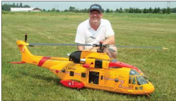
Ce CH 149 Cormorant l'échelle 1/10 a été construit de façon artisanale par Yvon Langevin, du Club Mars. Cette maquette est une réplique. La mécanique est de Benzin. La machine a débuté sa vie avec une motorisation à essence mais elle a été convertie à la motorisation électrique à l'aide de piles 10S. Le temps de construction a été de deux ans et Yvon a inscrit environ 125 vols dessus. L'hélicoptère vole comme il paraît : bien! / This 1/10 scale scratch-built Cormorant CH 149 was built by Yvon Langevin of Club Mars. The model is a replica. It has Benzin mechanics, starting as a gas machine, but is now electric using 10S batteries. It took two years to build and has approx 125 flights on it to date. It flies as good as it looks.
