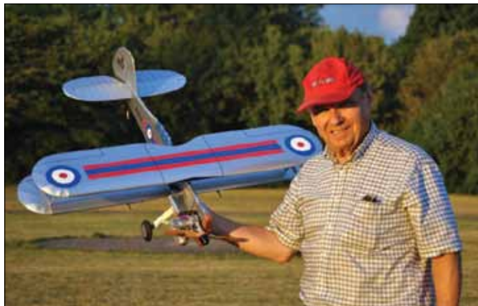
Chris Brownhill's Fun Scale Gloster Gladiator Mk 1 from Brodak "38 Special" kit. It is powered by an O.S. 40 FP R/C engine, with Roberts 3-line throttle control. It weight about 45 oz, is covered with dope and Monokote and is capable of mild aerobatics. / Le Gloster Gladiator Mark 1 (Fun Scale) de Chris Brownhill, construit à partir d'un kit 38 Special de Brodak. Celui-ci est mû par un O.S. 40 FP pour maquettes télécommandées, et possède un contrôleur des gaz Roberts à trois filins. La maquette pèse environ 45 onces et est recouverte d'enduit (dope) et de Monokote. Elle peut exécuter de l'acrobatie détendue.
