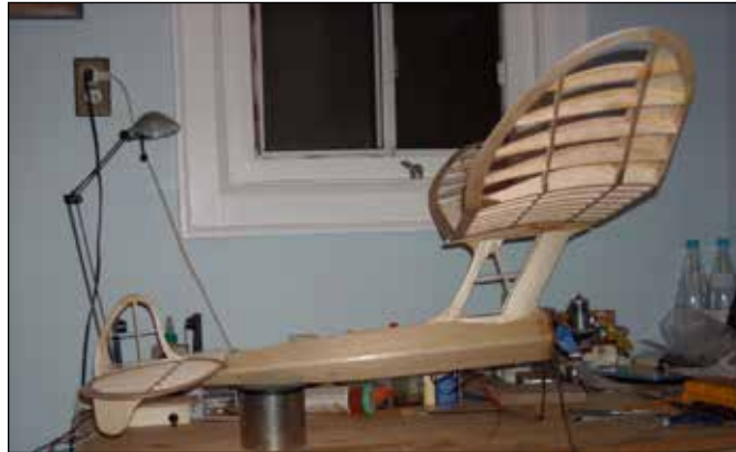
All framed up and ready for covering, a Swoose emerged from the author's workbench over the winter. / Sa cellule mise à nu, le Swoose a surgi de l'atelier de l'auteur au cours de l'hiver et est fin prêt à être recouvert.
