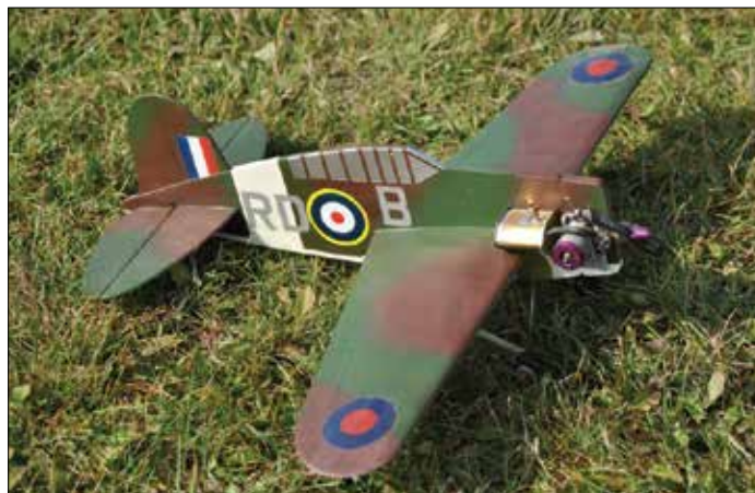
This profile scale Brewster Buffalo was designed and built by Gord Gimbert of the Toronto Balsa Beavers. The model has a 30" span, flies on a .09 engine and is fully aerobatic. / Cette copie volante de profil Brewster Buffalo a été conçue et construite par Gord Gimbert, des Toronto Balsa Beavers. Envergure de 30 pouces, motorisée par un .09 et entièrement acrobatique.
