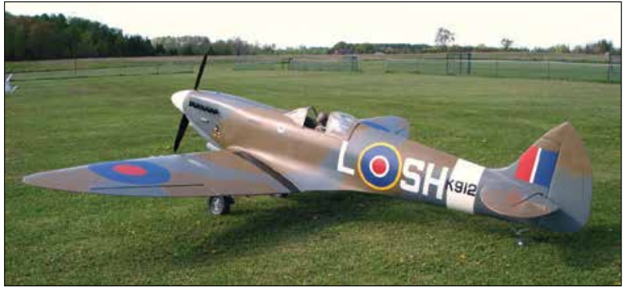
Walter Ernstberger's 112" span Supermarine Spitfire Mark IX built from Mick Reeves design using a ZDZ 80cc engine with a 25x10 XOAR prop. This plane is a replica of the Spitfire from the Russell Collection located in Niagara Falls Ontario. / Le Supermarine Spitfire Mark IX (envergure de 112 pouces) de Walter Ernstberger, construit à partir d'un design de Mick Reeves. Moteur ZDZ de 80 cc et hélice XOAR de 25 X 10. Cette maquette est la réplique de l'appareil de la collection Russell, à Niagara Falls (Ontario).
