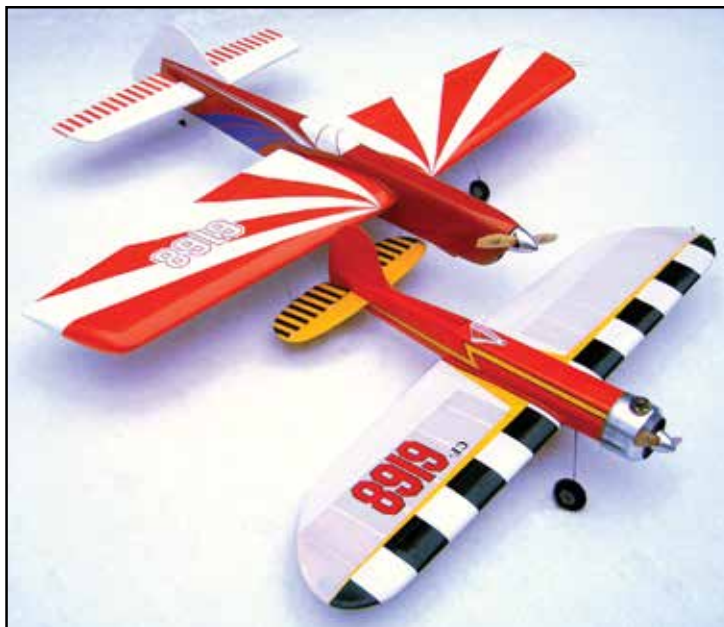
Sixty years of evolution. 1952 Galloping Comedian with a Fox .35, front, alongside a current SV-11 with a piped Ro-Jett BSE .65. / Soixante ans d'évolution. Voici un Galloping Comedian 1952, mû par un Fox .35 et à côté, un SV-11 moderne mû par un Ro-Jett BSE .65 avec tuned pipe.
