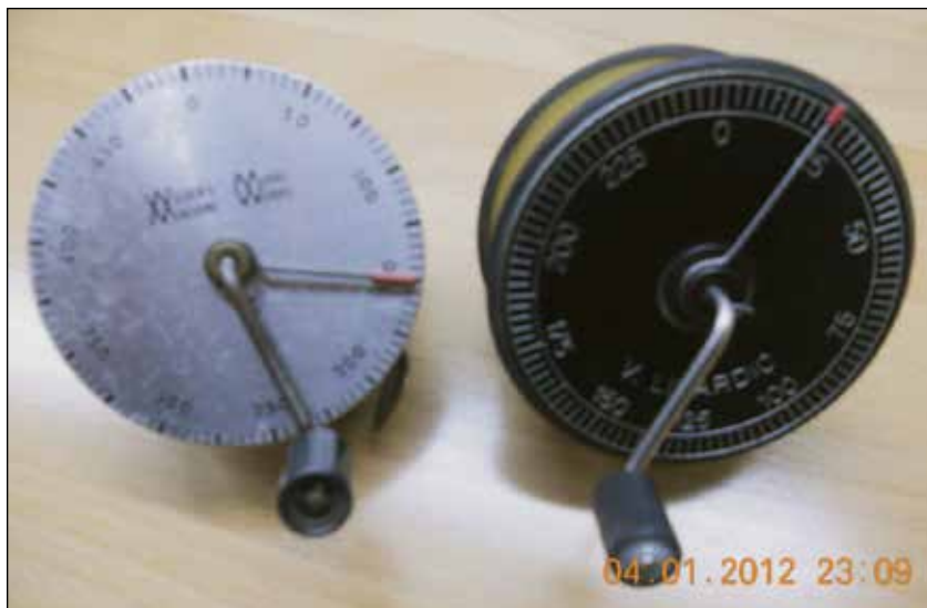
Left, the original well used 20:1 ratio winder, purchased from designer/builder Bob Wilder who used to make them commercially. It has a mechanical counter and uses plastic gears. Right: a winder built by Vladimir Linardic based on Wilder design, 10:1 ratio uses spiral gears for noise reduction, sealed roller bearings, mechanical counter and an internally integrated ball type output brake. / À gauche : un remonteur 20:1 que j'ai beaucoup utilisé, acheté du concepteur Bob Wilder, qui les fabriquait commercialement. Le compteur de tours est mécanique et l'engrenage est en plastique. À droite : un remonteur qu'a construit Vladimir Linardic, selon le design de Wilder. Rapport 10:1 avec engrenage spiral afin de réduire le bruit, des roulements scellés, un compteur mécanique de tours et un frein interne.
