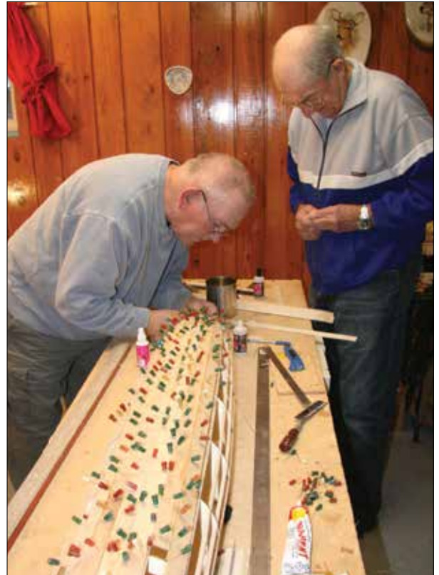
A Kenora (Ontario) team building C-46 project. Ron Pettigrew (left) and Ray Baker. Note the use of Pirozek pins to hold the planking while the Sigment glue sets. / Une équipe de Kenora (Ontario) en train de donner vie à un projet de C-46. Ron Pettigrew (à g.) et Ray Barker. Notez les épingles Pirozek afin de retenir les petites planches tandis que sèche la colle Sigment.
