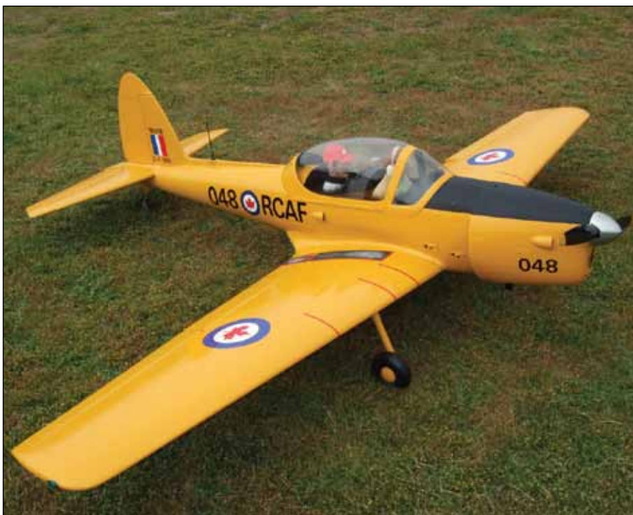
Bill Martin's 1/4 Scale Chipmunk. This is a beautiful scratch-built 103" wingspan model powered by a 50cc gas engine, super quiet exhaust and awesome smoke system. / La copie volante Chipmunk à l'échelle un quart de Bill Martin. Cette maquette artisanale d'une envergure de 103 pouces est mûe par un 50 cc à essence. Le silencieux fait du bon travail et Bill l'a dotée d'un système de fumée incroyable.
