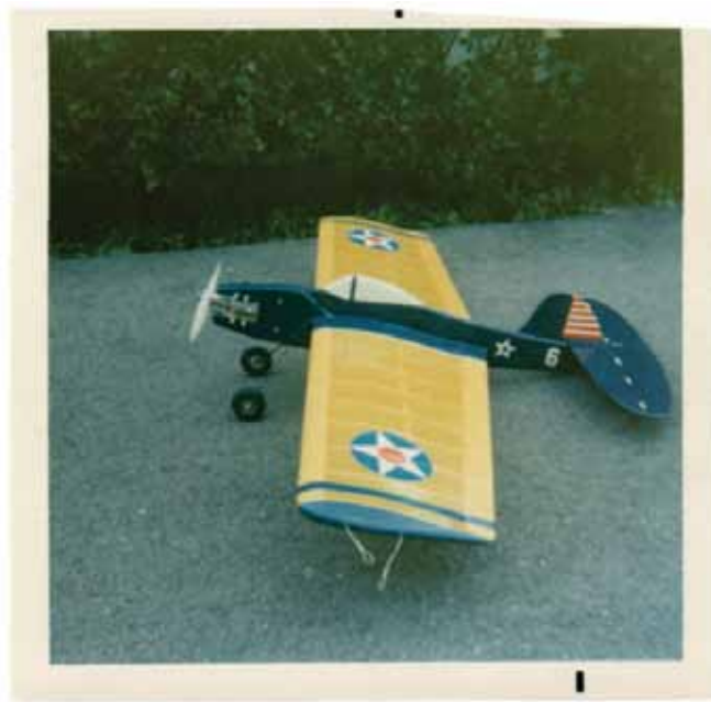
The author's Sterling Ring Master (circa 1970) with Johnson .29 Stunt power, silk covering, and USAAF colour scheme. It was not a particularly successful model due some trimming errors. But, it gives the flavour of old Control Line planes that came out in kit form in the early 1950s. / Le Ring Master de l'auteur (du fabricant Sterling, vers 1970) mû par un Johnson .29 Stunt, recouvert de soie et en livrée de la USAAF. Ce n'était pas une maquette très réussie en raison de problèmes d'ajustement. Mais elle donne un aperçu de ce qu'étaient les maquettes de vol circulaire au début des années 1950.
