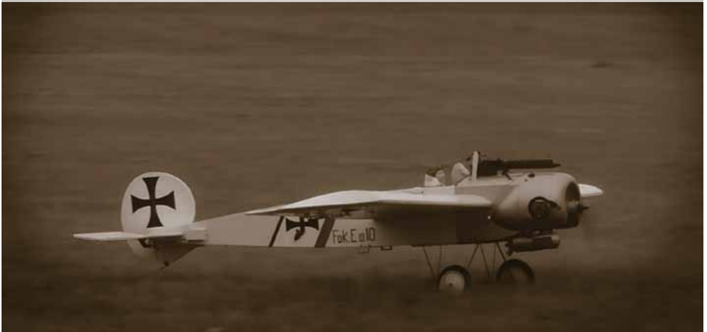
Tony Paladino built this very detailed Fokker E III Eindecker from a Balsa USA kit. Wingspan is 80". Power is an OS 1.08. The plane weighs 9.5 pounds. / Tony Paldino a construit son Fokker E III Eindecker (un kit de Balsa USA) et y a ajouté bien des détails. Envergure de 80 pouces, motorisation par un O.S. 1.08. La maquette pèse 9,5 livres.
