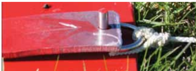
Launch pedal in safe position / La pédale de lancement est en position sécuritaire.
