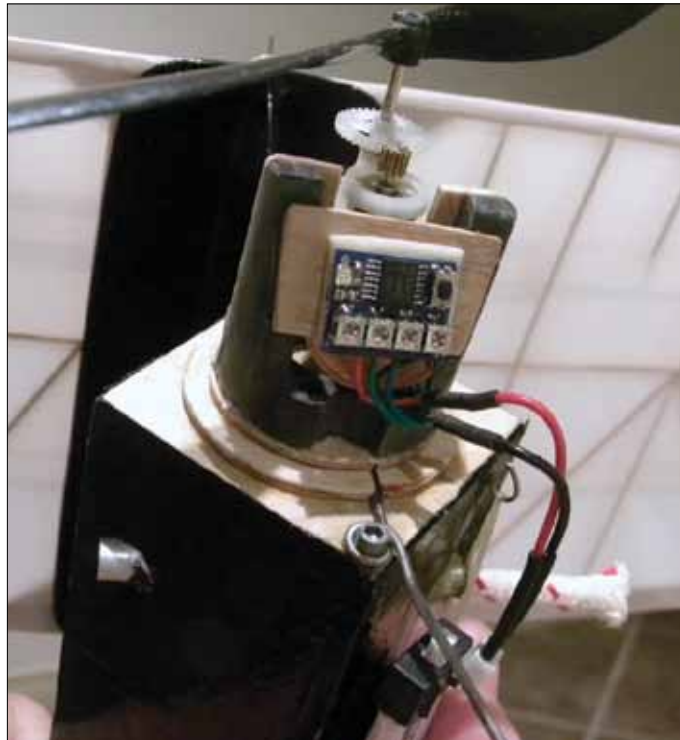
A "Zombie" controls engine run and power. / Un dispositif 'Zombie' contrôle le temps et la puissance moteur.
