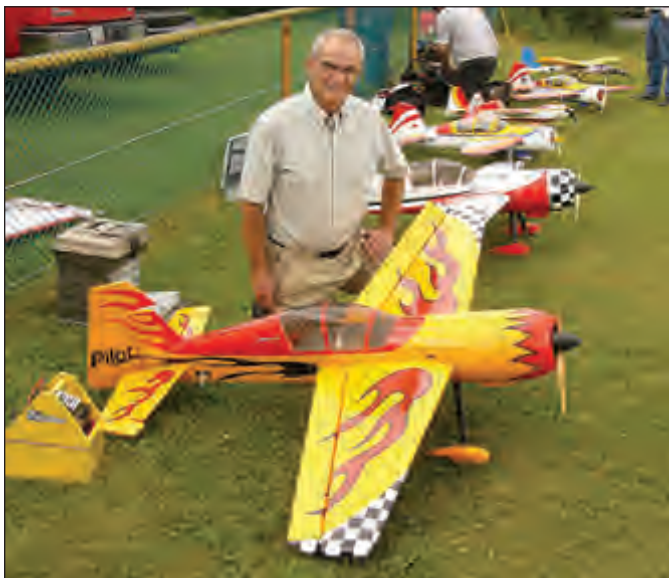
Gaston Boissonneault, left, and Hugh Harrison flew 26% Pilot Yak 54s, converted to electric with Hobby King SK 5065s on 8S LiPo's at the 4th annual NIPMAC Electric Fly in North Bay, Ontario. / Gaston Boissonneault, g, et Hugh Harrison ont piloté des Yak 54 à l'échelle 26 %, qu'ils ont convertis à la propulsion électrique grâce à des moteurs Hobby King SK 5065 sur piles Li-Po 8S, lors du quatrième Electric Fly annuel de North Bay (Ontario).
