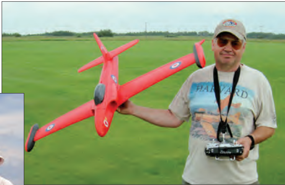
Ken Kalynuk's 'Red Knight' T-33 RCAF from an old Kyosho ARF. The model now flies with a HET 6904 fan and Mega 16/15/2 brushless motor, this EDF model flies superbly on 2x 3S-2200 for a five-minute flight. / Le Chevalier rouge de Ken Kalynuk, un T-33 de la RCAF, réalisé à l'aide d'un vieux kit prêt à voler de Kyosho. La maquette vole maintenant à l'aide d'un tel dispositif HET 6904 et d'un moteur sans armature (brushless) Mega 16/15/2. Cette maquette vole superbement sur deux piles 3s-2200, ce qui lui confère un temps de vol de cinq minutes.
