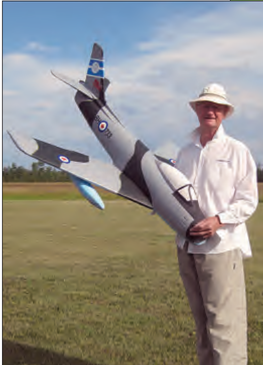
Ken Kalynuk's 'Red Knight' T-33 RCAF from an old Kyosho ARF. The model now flies with a HET 6904 fan and Mega 16/15/2 brushless motor, this EDF model flies superbly on 2x 3S-2200 for a five-minute flight. / Le Chevalier rouge de Ken Kalynuk, un T-33 de la RCAF, réalisé à l'aide d'un vieux kit prêt à voler de Kyosho. La maquette vole maintenant à l'aide d'un tel dispositif HET 6904 et d'un moteur sans armature (brushless) Mega 16/15/2. Cette maquette vole superbement sur deux piles 3s-2200, ce qui lui confère un temps de vol de cinq minutes.
