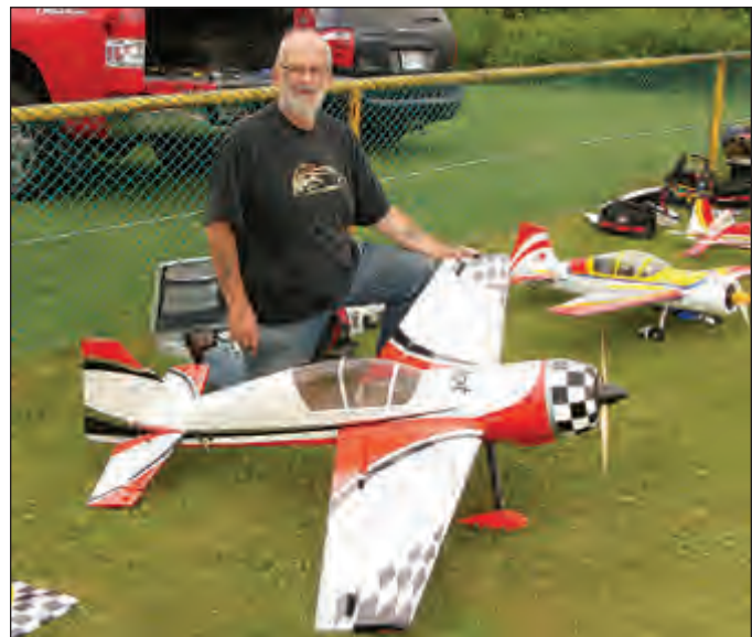
Gaston Boissonneault, left, and Hugh Harrison flew 26% Pilot Yak 54s, converted to electric with Hobby King SK 5065s on 8S LiPo's at the 4th annual NIPMAC Electric Fly in North Bay, Ontario. / Gaston Boissonneault, g, et Hugh Harrison ont piloté des Yak 54 à l'échelle 26 %, qu'ils ont convertis à la propulsion électrique grâce à des moteurs Hobby King SK 5065 sur piles Li-Po 8S, lors du quatrième Electric Fly annuel de North Bay (Ontario).
