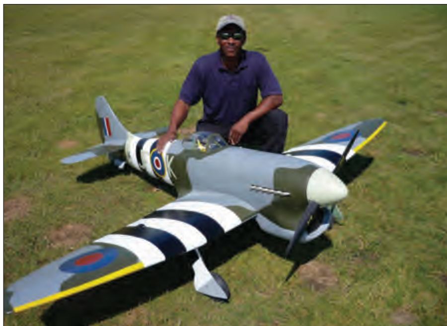
Dennis Hartley's 1/5 scale Tempest MKV from Vailly Aviation. It has a 96-inch wingspan, powered by a ZDZ 80RV engine, 26X10 Xoar prop, scale retracts and weighs 45 lbs. / Le Tempest MK V de Dennis Hartley à l'échelle 1/5, réalisé depuis des plans de Vailly Aviation. L'envergure est de 96 pouces, la motorisation est assurée par un ZDZ 80RV, l'hélice est une Xoar, la maquette est dotée d'un train escamotable reproduisant le véritable et elle pèse 45 livres.
