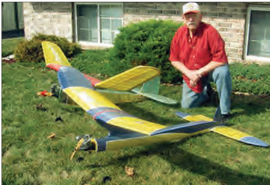
SAM members like to build big airplanes. Chuck Schooley shows off his enlarged Civy Boy, front, scaled up from the 74" version featured in Model Airplane News around 1950. As you can see from the photo, it's beautifully covered in silk and dope and powered by a Royal 46. The second model is a Lanzo Record Breaker originally built by Chuck's son David as a 14-year-old back in the pre-computer days. Today Chuck flies it on RC and it's powered with an OS .61 four-stroke. / Les membres du SAM aiment bien construire de grosses maquettes. Chuck Schooley exhibe son Civy Boy (à l'avant), qu'il a agrandi depuis les plans d'une version de 74 pouces d'envergure, un jeu de plans que renfermait Model Airplane News vers 1950. Comme vous pouvez le constater grâce à la photo, la maquette est recouverte de soie et d'enduit vernis et est mue par un Royal .46. La deuxième maquette est un Lanzo Record Breaker, qu'a construit le fils de Chuck à l'âge de 14 ans... avant l'ère des ordinateurs. Aujourd'hui, Chuck pilote ce dernier par télécommande. Un OS .61 fournit la motorisation.
