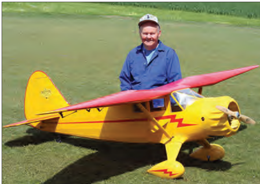
Bill Pottages' 1/4 Scale Stinson DR 10 Reliant built from Wendell Hostetler plans with a 125-inch wingspan, weighs 38lbs, powered by a GT80 engine, is covered in Century 21 covering. / Le Stinson DR 10 Reliant à l'échelle 1/4 de Bill Pottage a été construit à partir de plans de Wendell Hostetler et possède une envergure de 125 pouces, pèse 38 livres et est mû par un GT80. Le recouvrement est le produit Century 21.
