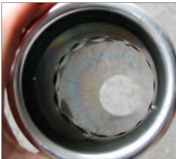
One example of an exhaust tube that's seen one too many hot starts, note the dimple shapes. / Un exemple du tuyau d'échappement qui a souffert d'un hot start de trop : notez les fossettes (creux) sur sa surface.
