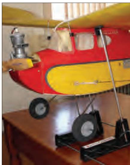
The author's Buzzard Bombshell spends some quality time on the CG Machine. / L'auteur passe du temps de qualité sur la CG Machine.
