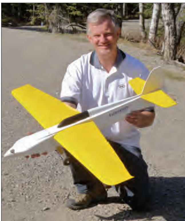
Dave Sawers proudly displays the first E-F1 model built and flown in Canada. Dave's Nemesis electric pylon racer has 375 sq. inches of wing, weighs in at 3.25 lbs. Power system: Turnigy SK3452 1250KV motor, APC 8x8E, Turnigy Plush 60A ESC, 3S-2650mAh battery pack. / Dave Sawers exhibe fièrement la première maquette E-F1 construite et qui ait volé au Canada. Son Nemesis possède une surface alaire de 375 pouces carrés et pèse 3,25 livres. Motorisation : moteur Turnigy SK3452 de 1 250KV, hélice APC 8x8E, contrôleur de vitesse Turnigy Plush 60A ESC, piles 3S-2 650 mAh.
