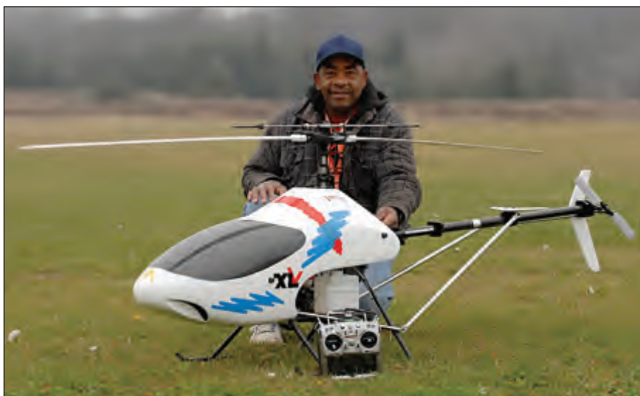
Michel Côté, President of HéliFun Québec with his own designed / engineered .90 sized electric machine which he calls the MC-690. It has a Neu 1912h/1.5Y motor and a Kontronc 80 Jive esc. He also has a 12S 5000 mah set-up and a flying weight of 4470 g. This photo was taken in Québec City at the summer Fun Fly, last June. He has also flown it at last summer's meet in Muncie at the IRCHA jamboree. / Michel Côté, président d'HéliFun Québec avec une machine électrique de sa propre conception. Cette machine électrique de puissance .90 s'appelle le MC-690. L'hélicoptère est mû par un moteur Neu 1912h/1.5Y et un contrôleur de vitesse Kontronc 80 Jive en contrôle les paramètres. Jean a installé des piles 12S de 5 000 mah afin d'atteindre un poids prêt à voler de 4 470 grammes. La photo a été croquée au cours du Fun-fly estival de juin à Québec. Michel l'a piloté à Muncie, pendant le jamboree IRCHA.
