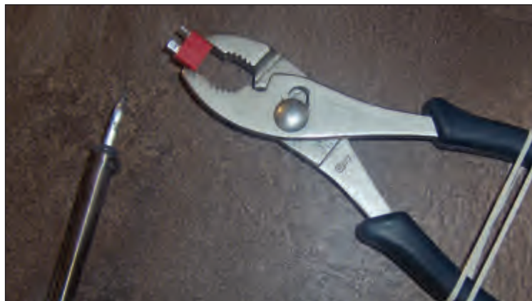
A favoured tool of mine, a simple idea that I could simply not be without: an elastic band wrapped around the handles of your favoured pliers makes for a great extra hand! / Un outil qui m'est très cher et une idée toute simple dont je ne pourrais me passer : un élastique ceinturant les poignées de votre paire de pinces préférées... c'est comme une main de plus!
