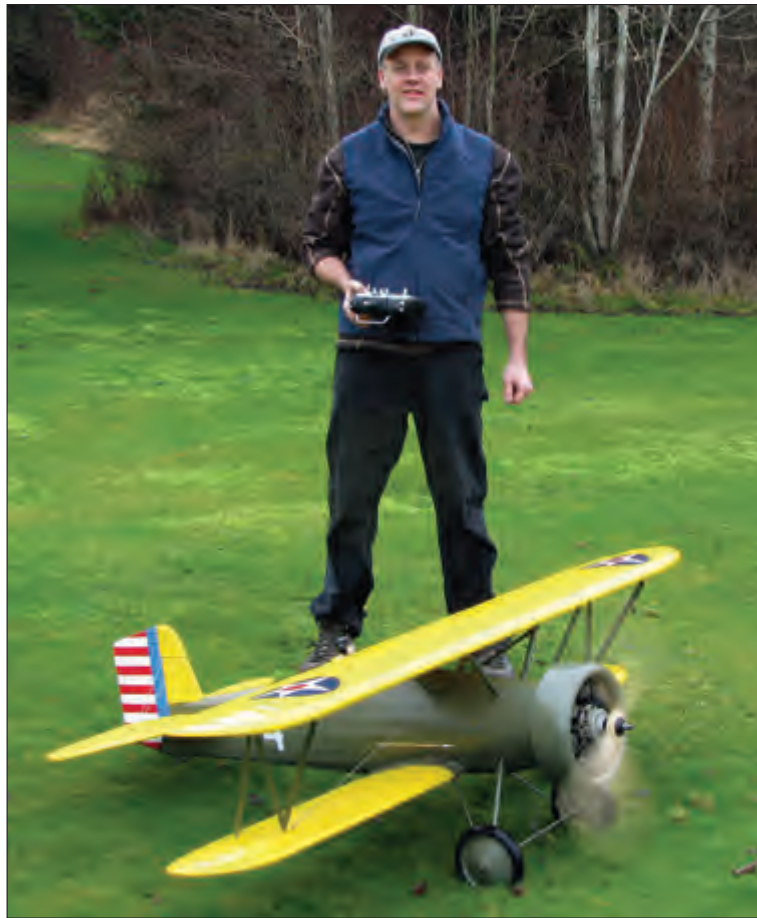
Jim Petrus' beautiful scratch-built Boeing P-12C at the RCAA Flying Field in Mer-ville. Jim re-scaled the original RCM plan to 22.5% to match the Seidel st 770 m seven-cylinder radial engine which turns a 24X8 prop at 6000 RPM. The model is 1780 sq. in and weighs 23.4 lbs dry. / Le magnifique Boeing P-12C de Jim Petrus, de construction artisanale, au au terrain de la RCAA à Merville. Jim a adapté les plans originaux de la revue RC Modeler afin qu'ils soient à 22 %, de sorte à ce que la maquette soit de la bonne dimension pour le moteur radial Seidel st 770 à sept cylindres, qui réussit à faire tourner une hélice 24 X8 à 6 000 tours/minute. Le Boeing miniature comporte une surface alaire de 1 780 pouces carrés et pèse 23,4 livres, sans carburant. PHOTO: Jim Lindsay
