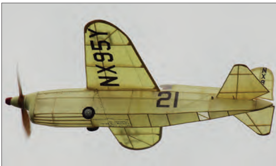
Bernard Guest's dimescale R-1 Chambermaid. The wingspan is about 16 inches, weight 20 grams. Le Chambermaid R-1 à l'échelle Dimescale de Bernard Guest. Envergure : environ 16 pouces, poids d'environ 20 grammes.
