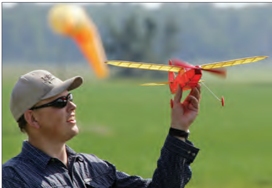
Bernard Guest with his FAC Moth an 25 inch oldtimer. The model is scratch built off plan, weighs 25 grams empty and uses 10 grams of rubber, 4 strands of 1/8th, and an 8 inch prop. / Bernard Guest en compagnie de son FAC Moth, un Old Timer d'une envergure de 25 pouces. La maquette est de construction artisanale depuis des plans, elle pèse 25 grammes à vide et utilise quatre filins de caoutchouc de 1/8 de pouce (10 grammes) et une hélice de 8 pouces.
