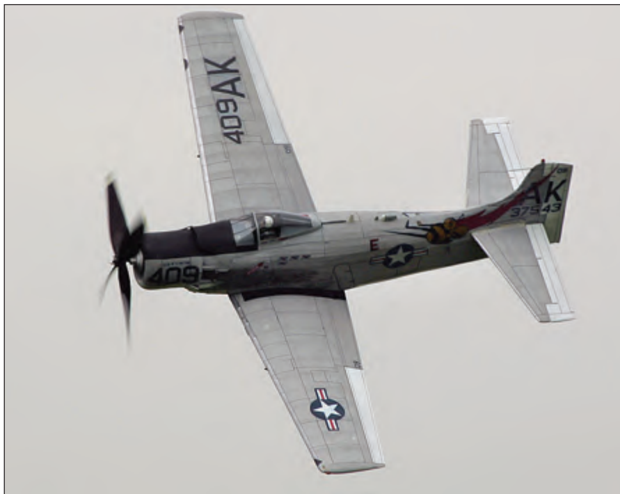
Bernard Guest's A1H Skyraider, his first serious scale model. It was built from scratch using a highly modified Walt Mooney plan and weighs 90 grams empty. The prop is two Ikara props glued together and is powered by about 30 grams of rubber, 10 strands of 1/8th inch. / Le Skyraider A1H de Bernard Guest, sa première copie volante proprement dite. Il l'a construite artisanalement depuis des plans Walt Mooney modifiés et elle pèsera 90 grammes à vide. L'hélice en est en fait deux d'Ikara collées ensemble. La motorisation sera assurée par du caoutchouc de dix filins de 1/8 de pouce et pesant une trentaine de grammes.
