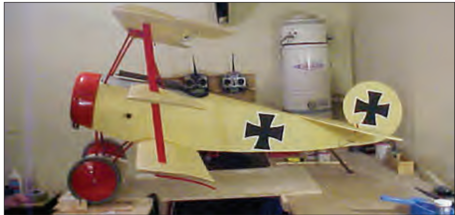
Ron Dodd's Fokker DR1 154/17. Scratch built from his own plans it comes in with a 88" wing span, 2881 sq. inches wing area and will use a Turnigy 63-74-170 motor, 28 X 14 prop and six 4000mah zippy lithium cells. The plane is covered with World tex covering and will weigh approx 12 pounds. / Le Fokker DR1 154/17 de Ron Dodd. Ce dernier l'a construit d'après ses propres plans. Envergure de 88 pouces, surface alaire de 2881 pouces carrés et la motorisation sera assurée par un Turnigy 63-74-170, hélice de 28 X 14 et par six piles Zippy au lithium de 4 000 mah. L'avion est recouvert de Worldtex et pèsera environ 12 livres.
