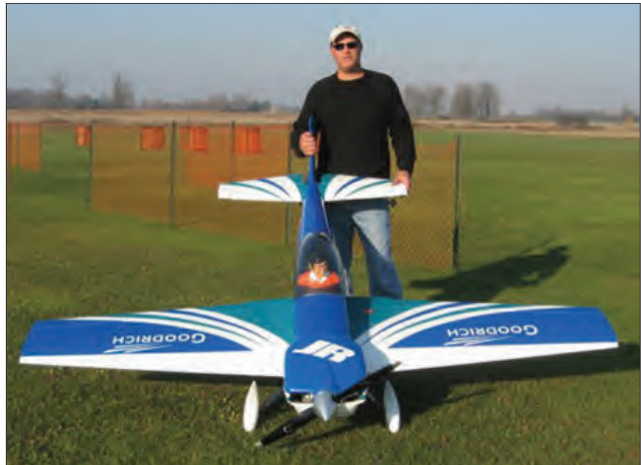
Keith Schneider of the Forest City Flyers with his 102" span Carden Cap 232. The model is powered by a DL 100 and a 27x10 XOAR prop resulting in unlimited vertical performance. / Keith Schneider, des Forest City Flyers avec son Cap 232 (de Carden), d'une envergure de 102 pouces. Cet avion est mû par un DL100 et une hélice XOAR de 27x10, ce qui lui confère une performance verticale illimitée.
