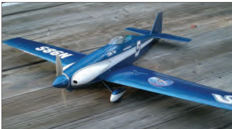
An example of the new E-F1 model design emerging from the United States. This is the LR-1A designed and built by Jerry Small. Wing area: 375 sq. in, Weight: 3.25 lbs, Motor: 1250 Kv, Battery: 4S-2650/30C, Prop: 8x6 APC. Speed is in the range of 110 – 120 mph. The model is standard built-up construction with shrink plastic covering. Some of cowls and turtledecks are made from molded parts. / Un exemple du nouveau design de E-F1 qui arrive des États-Unis. Il s'agit du LR-1A, qu'a conçu et construit Jerry Small. Surface alaire : 375 pouces carrés. Poids : 3,25 livres. Moteur : 1250 kv. Piles : 4S-2650/30C. Hélice : 8x6 APC. La vitesse est de 110 à 120 milles à l'heure. La construction est conventionnelle et le recouvrement est du plastique thermorétractable. Quelques capots et turtledecks sont façonnées par moulage de plastique. PHOTO: Jerry Small.
