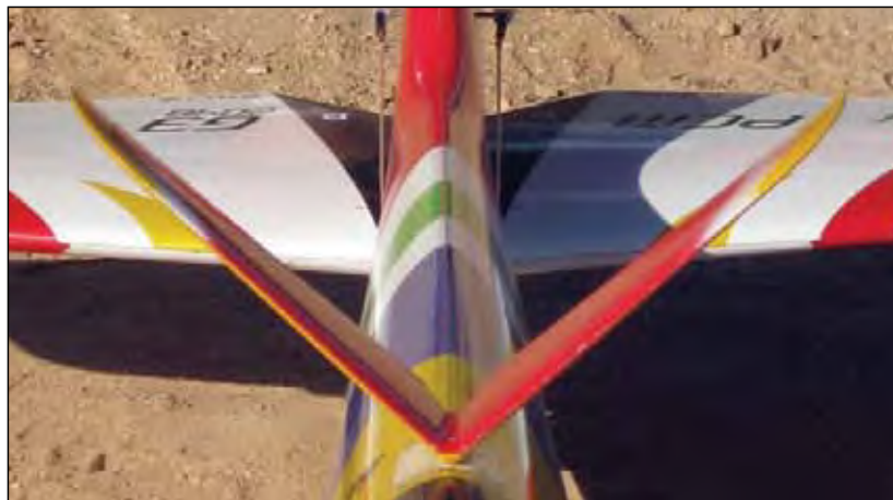
Krill Aircraft Spark modified with two angled fins / Le Spark (de Krill Aircraft) modifié avec deux gouvernes en angle.
