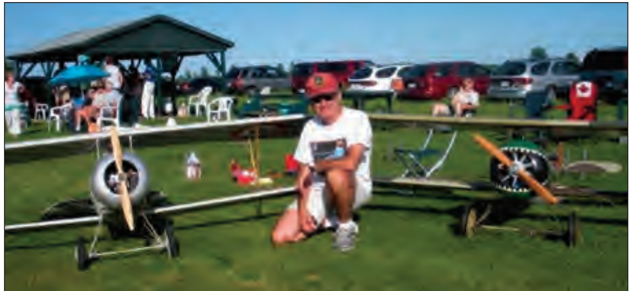
Claudio DeMinico poses with his 1/3 scale Nieuport 17 (at left) replica of that flown by French ace Lt. Maurice Boyau in 1917. At right, his 1/3 scale Nieuport 28 reproduction of the one flown by Lt W.H. Taylor of the 95th Aero Squadron in 1918. Both planes are Balsa USA kits covered with Solartex painted with custom-blended latex colors. Both planes feature detailed cockpits, working pull-cables and all of the markings and drawings are handpainted. The engines are Zenoah 62 and Fuji 64 respectively. Each plane took approximately 500 hours to complete. / Claudio DeMinico pose en compagnie de sa copie volante Nieuport 17 à l'échelle 1/3, une réplique de l'appareil à bord duquel volait l'as français le lieutenant Maurice Boyau en 1917. À droite, son Nieuport 28 à l'échelle 1/3, qui reproduit l'appareil à bord duquel volait le lieutenant W. H. Taylor, de la 95e Escadre aérienne en 1918. Les deux maquettes sont des kits de Balsa USA recouvertes de Solartex sur lesquelles des couleurs de latex spécialement mélangées ont été appliquées. Les deux avions miniatures possèdent chacun un cockpit détaillé, des câbles de gouvernes fonctionnels; toutes les cocardes et dessins sur les fuselages ont été réalisés à la main. Les moteurs sont respectivement un Zenoah 62 et un Fuji 64. Chacune des maquettes a nécessité environ 500 heures de travail.
