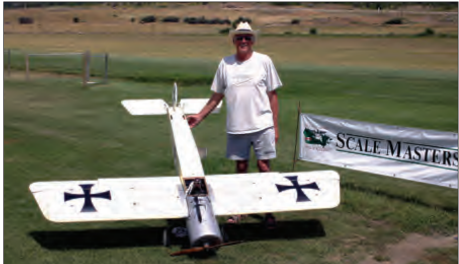
Les Isted from Vernon, B.C. & his 1/4 scale scratch-built Eindecker. Wingspan 102", weight 23lbs. Engine is a 45 gas Zenoah. Les was 1st in Open class. / es Isted de Vernon (C.-B.) et son Eindecker à l'échelle ¼ de construction artisanale. L'envergure est de 102 pouces, le poids est de 23 livres. Le moteur est un Zenoah 45 à essence. Les a terminé premier dans la catégorie Open.
