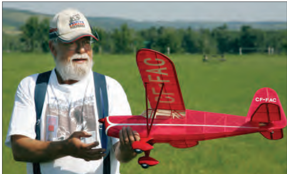
Grant Sauerberg shows his 36" Rearwin Speedster, from an Easibuilt kit. Weight is under 4 ozs., 11" prop powered by 4 x 3/16". Covering is Japanese tissue with all decals handcut from mylar trim sheet .... nice work/ Grant Sauerberg exhibe son Rearwin Speedster de 36 pouces, qu'il a construit depuis un kit Easibuilt. Le poids est sous la barre des 4 onces. L'hélice de 11 pouces tourne à l'aide de caoutchouc de 4 X 3/16 de pouce. Le recouvrement est du tissu japonais et tous les décalques ont été découpés à la main dans une feuille de mylar... Beau travail.
