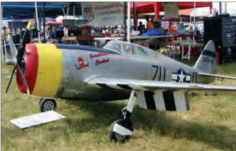
Al Walker's 1/4 Scale P47 Thunderbolt at Warbirds over Delaware. The model is built from Don Smith Plans, has a 122" span and weights in a 70 lbs with fuel. This beauty is powered by a 21.5 hp Cactus Aviation 4 cylinder swinging a 32x14 prop. / Le P-47 Thunderbolt à l'échelle ¼ d'Al Walker lors du rassemblement Warbirds over Delaware. La maquette a été construite depuis des plans de Don Smith. Elle possède une envergure de 122 pouces et pèse 70 livres avec carburant. Un moteur quatre cylindres de 21,5 chevaux de Cactus Aviation (faisant tourner une hélice de 32 X 14) propulse le "Jug".
