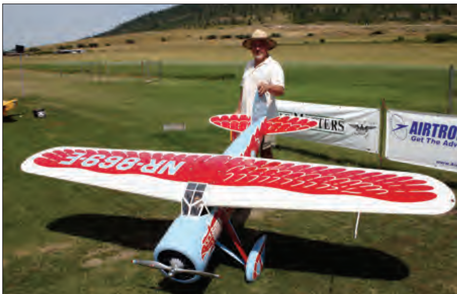
Pilots Choice award Winner Nigel Tarvin from Chilliwack B.C. with his scratch built, 1/4 Scale "Lockheed Vega"; engine 70cc Minarelli Twin, 24" prop., wingspan 123" / Nigel Tarvin, gagnant du choix des pilotes, de Chilliwack (C.-B.) et son Lockheed Vega de construction artisanale à l'échelle 1/4; le moteur est un bicylindre Minarelli de 70cc, il possède une hélice de 24 pouces, une envergure de 123 pouces et un poids de 37 livres.
