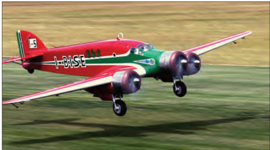
Nigel Tarvin's 1/6 scale Savoia Marchetti S.79. It sports a 138" span, and weighs 54 lbs 2ozs. It has working leading edge slats and navigation lights. / Le Savoia Marchetti S.79 à l'échelle 1/6 de Nigel Tarvin. Il possède une envergure de 138 pouces et pèse 54 livres et 2 onces. Il est doté de slats sur le bord d'attaque ainsi que des feux de navigation fonctionnels.
