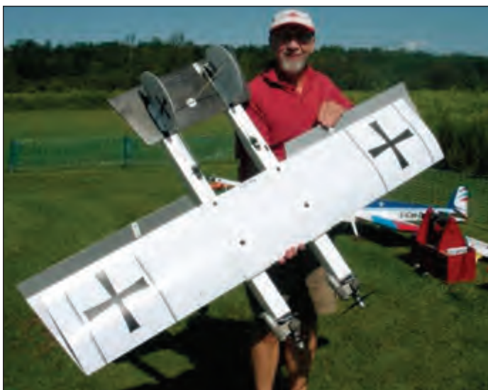
Robert Thibert with his Twin SPAD made of Coroplast and rain gutter material. The model is powered by two OS LA40s. Robert Thibert et son Twin SPAD, fabriqué à l'aide de Coroplast et de matériel à gouttière. Deux moteurs OS LA .40 propulsent cette maquette.
