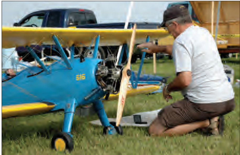
Karl Gross with his new Stearman. Beautiful and scratch-built, 250 RCS Engine, 5 cylinder radial, 15 hp. / Karl Gross et son nouveau Stearman. Ce magnifique appareil est de construction artisanale, est mû par un RCS 250 radial à 5 cylindres d'une puissance de 15 chevaux.
