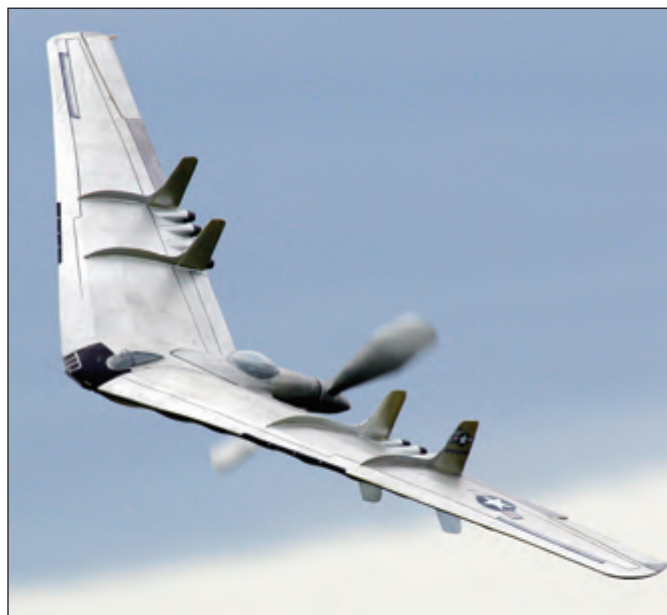
A YB49 flying wing built by Bernard Guest from a Vance Gilbert plan. Approximately 20 grams of rubber (12x1/8") turns a 13" prop for flights of approximately 60 seconds. Weight is 150 grams. / Une aile volante YB49 qu'a construite Bernard Guest depuis un plan de Vance Gilbert. Environ 20 grammes de caoutchouc (12 X 1/8 de pouce) font tourner une hélice de 13 pouces afin de réaliser un chrono d'environ 60 secondes. Le poids de la maquette est de 150 grammes. PHOTO : Craig Limber
