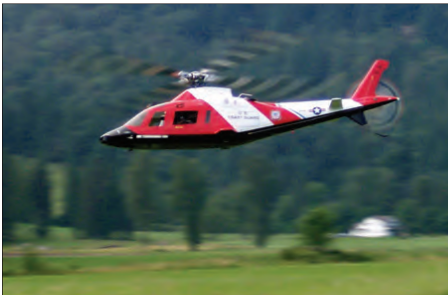
Mark's four-bladed modified electric T-600E with the detail Century A-109 Coast Guard fuselage. / Le A-109 électrique de Mark (selon une mécanique modifiée de T-600E) de la Garde côtière avec une tête à quatre pales.
