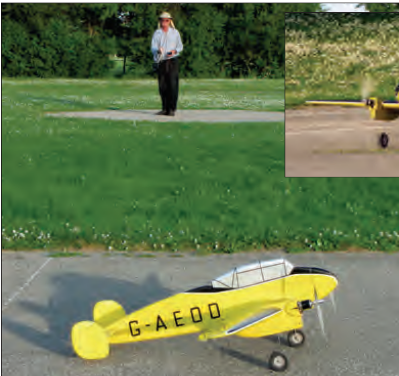
Reid and Sigrist S.R. 1 Snargasher Profile Scale model powered by two .25 Electric Motors with Lithium Polymer Batteries. Motor Control is through a Spread Spektrum Radio and the model weighs about 80 oz. / Cette maquette profil de copie volante du Reid et Sigrist S.R. 1 Snargasher est mûe par deux moteurs électriques .25 et des piles à la polymère de lithium. Le contrôle des moteurs s'effectue à l'aide d'un émetteur Spektrum et la maquette pèse environ 80 onces.
