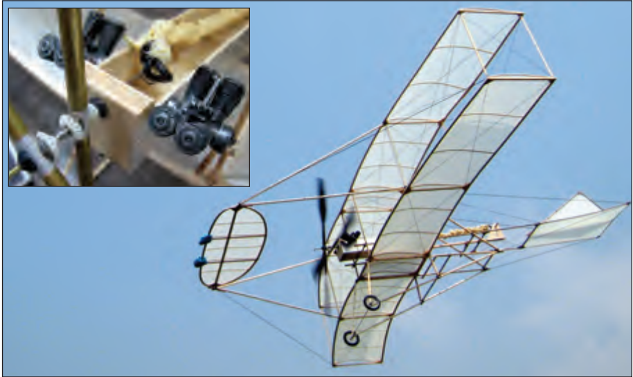
Ronny Gosselin (Montréal) sent this shot of his Ferber Type 8 twin engine – the first aircraft to utilise contra-rotating propellers, which he has incorporated in this 32" version built from an early three-views of the full-size aircraft. Flying weight is 32 grams / Ronny Gosselin (de Montréal) a envoyé cette photo de son bimoteur Ferber type 8 – le premier aéronef à se servir d'hélices contre-rotatives – et qu'il a incorporées dans sa version d'une envergure de 32 pouces en étudiant des diagrammes trois-views de l'avion à l'échelle réelle. Le poids prêt à voler est de 32 grammes.
