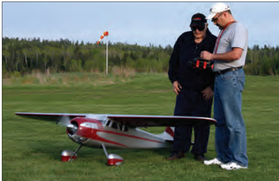
John Pirozek and Marc Sharpe get John's Cessna 195 ready for flight. The model was scratch built from Hostetler Plans and has a 108" wingspan. / John Pirozek et Marc Sharpe préparent le Cessna 195 du premier pour le prochain vol. La maquette a été construite à partir de plans de plans Hostetler et possède une envergure de 108 pouces.
