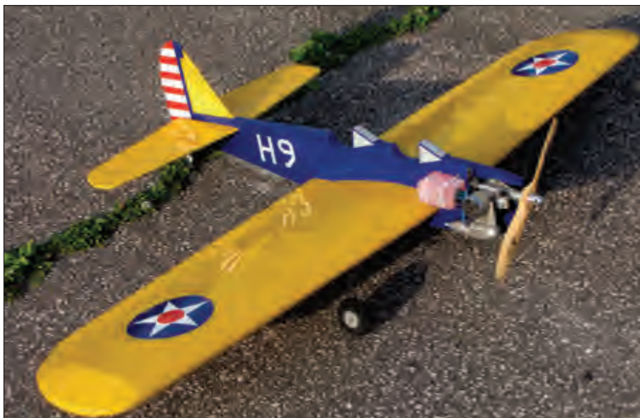
Lennie Bourel's Hangar 9 PT-19 ARF Profile Scale Model with O.S. .40-LA R/C engine and a three-wire Robert throttle control system. Model weight - 40 oz. / La maquette profil de copie volante PT-19 de Lennie Bourel, un produit de Hangar 9 et mue par un O.S. .40-LA pour avions télécommandés, est dotée d'un système des gaz Robert à trois filins. La maquette pèse 40 onces.
