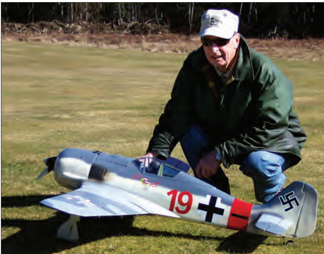
John Rugg with his beautiful scratch-built Focke Wulf 190 at the RCAA field in Merville. The airplane was built from Brian Taylor Plans. It has a 60" wingspan, retracts, flaps and is powered with an OS .91 four stroke. / John Rugg et son magnifique Fock Wulf 190 de construction artisanale au terrain de la RCAA à Merville. Cette maquette a été construite à l'aide d'un jeu de plans de Brian Taylor. L'envergure est de 60 pouces et l'avion possède un train escamotable, des volets et est mû par un O.S. .91 à quatre temps.
