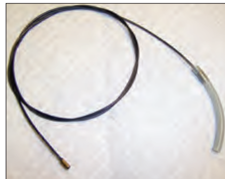
A length of flexible braided steel cable with 1/8 inch pieces of brass tubing soldered to the ends makes a nifty fuel line puller. / Une certaine longueur de câble flexible auquel ont été soudés des tubes de laiton d'un huitième de pouce aux extrémités, voilà qui fait un bien bel outil afin d'extraire les conduites de carburant.
