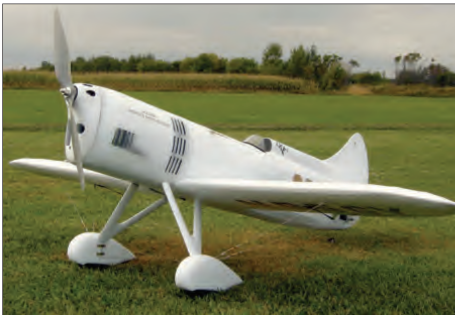
Jean Tardif, from the Escadrille du Haut-Richelieu in Saint-Hubert, Québec, scratch-built this beautiful Benny Howard DGA-5 "Ike" racer. This 56" span, balsa & ply plane is covered with Solartex & dope and is powered by a Hacker A50-14L turning an 18x10 prop on 6 Lipo cells putting out 1125 watts. / Jean Tardif, de l'Escadrille du Haut-Richelieu à Saint-Hubert (Québec) a construit artisanalement ce magnifique Howard DGA-5 Ike de course. Cette maquette de balsa et de contreplaqué possède une envergure de 56 pouces, est recouverte de Solartex et de vernis et est mûe par un Hacker A50-14L qui fait tourner une hélice de 18 X 10 à l'aide de six éléments LiPo de 1 125 watts.
