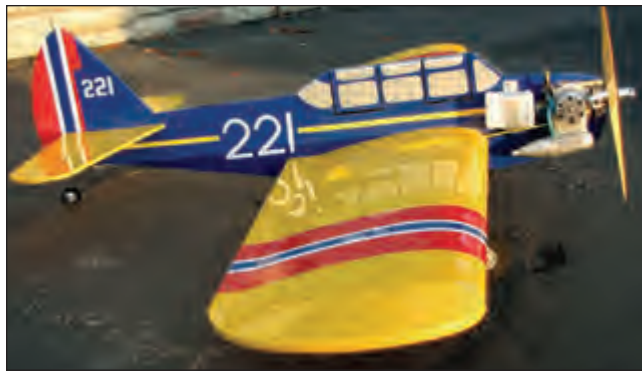
Chris Brownhill's profile scale model of Cornell Trainer (WWII) in Norwegian colours. OS Max .40 LA Power. The model is a modified Hangar 9 ARF PT-19, with 3-line throttle bellcrank. / La maquette profil de Chris Brownhill d'un appareil d'entraînement Cornell (de la Seconde guerre mondiale) en livrée norvégienne. Le moteur est un O.S. Max .40 LA. La maquette presque prête à voler (ARF) est un PT-19 modifié de Hangar 9, muni d'un bellcrank à trois filins (le troisième étant pour le régime moteur).
