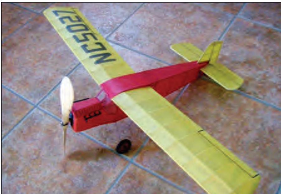
Paul Davies, Ontario, sent this photo of his "Curtiss Robin" built from plans published in Air Trails , April 1946. Span is 30", weight 51 grams and, with a 10" prop, is presently flying well on only four strands of 1/8" though Paul expects to upgrade to six strands when a larger flying site is available to him / L'Ontarien Paul Davies nous a envoyé cette photo de son Curtiss Robin, construit à partir de plans publiés dans la revue Air Trails en avril 1946. Envergure : 30 pouces, poids : 51 grams et grâce à une hélice de 10 pouces, cette maquette vole très bien, mûe par un élastique à quatre torons de 1/8 pouce. Paul voudrait augmenter le caoutchouc à six torons lorsqu'il aura accès à un emplacement de vol plus grand.
