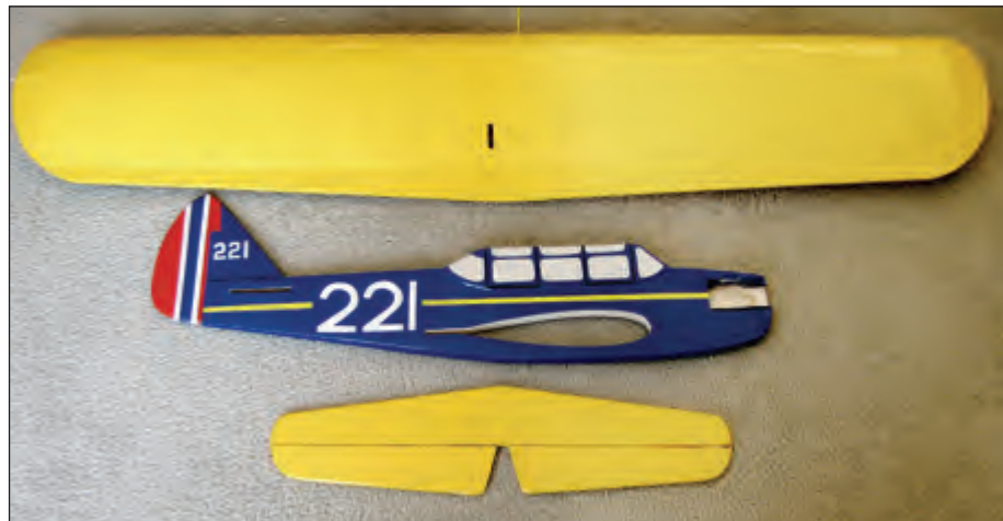
Hangar 9 PT-19 "ARF" Control Line model modified with Royal Norwegian Air Force markings and 3-wire Roberts bellcrank for Fun or Profile Scale. The model is Suitable for .36 to .46 engines. / Une maquette presque prête à voler (ARF) du PT-19 (de Hangar 9) modifiée afin de représenter la livrée de la Royal Norwegian Air Force et munie d'un bellcrank Roberts de trois filins pour les épreuves Fun ou Profile. Les moteurs passant de .36 à .46 de cylindrée conviendront parfaitement.
