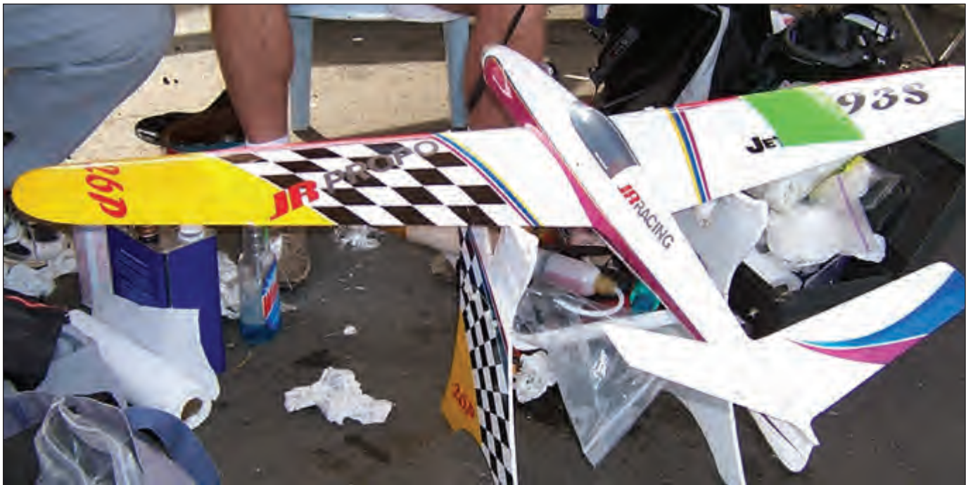
The new Sweet Vee, unique V-tail Q40 racer from Adrenaline Products. .40 size racing engine from Nelson Competition Engines, APC 7.4 x 7.6 carbon propeller turning 24,000 rpm, wingspan 56 inches, weight – 4.0 lbs, speed 190 mph. / Le nouveau Sweet Vee pour la course Q40, unique de par son empennage en V (d'Adrenaline Products). Le moteur .40 provient de Nelson Competition Engines; l'hélice est une APC 7.4 X 7.6 en carbone et tourne à 24 000 tours/minute. Le Sweet Vee possède une envergure de 56 pouces, pèse 4.0 livres et vole à 190 milles à l'heure.
