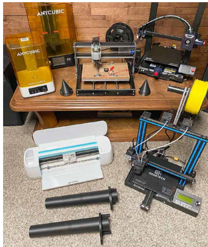
3D tech - AnyCube X2 immersion 3D printer, Genmitsu 3018Pro CNC cutter, AnyCube Neo 3D printer, Cri-cut, and older Geeetech A10M. No going back./ Techno 3D -- Imprimante AnyCube X2 immersion en 3D, machine CNC à découper Genmitsu 3018Pro, imprimante AnyCube Neo en 3D, Cri-Cut et une plus ancienne Geeetech A10M. Point de non-retour.
