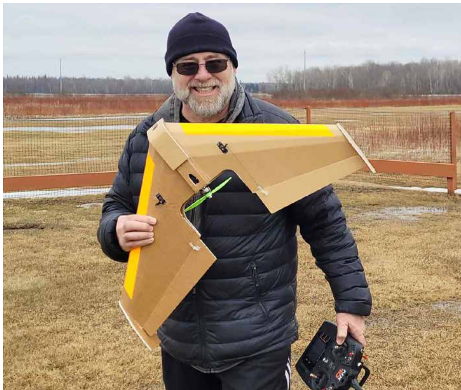
Rick Ramalho of the Stetson Flyers Club in Ottawa with his FliteTest Mighty Mini Arrow. Waterproof foam board construction. / Rick Ramalho, des Stetson Flyers d'Ottawa et son Mighty Mini-Arrow (un produit de FliteTest). La construction de foambord a été imperméabilisée contre l'eau.
