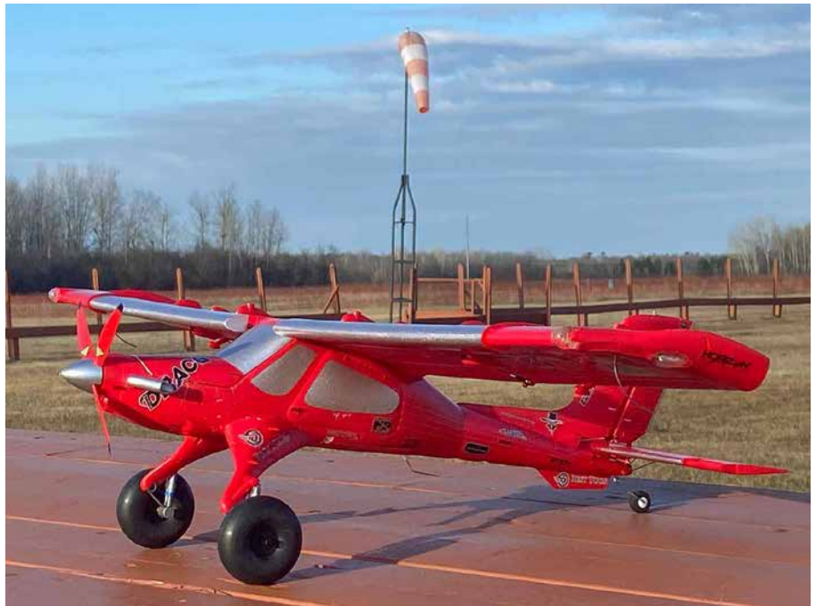
Another "big little plane", the new E-Flite Micro Draco. Wingspan 800mm, weight with 45 battery 239 grams. / Un autre "gros petit produit" d'E-Flite, le nouveau Micro Draco. Envergure de 800 mm, poids de 239 grammes (avec batterie 45).
