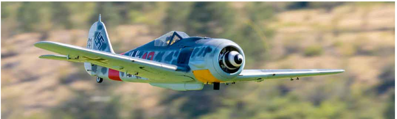
Michael Allman's Focke-Wulf gasoline-powered three-cylinder Saito engine. / Le Focke-Wulf de Michael Allman, mû par un trois-cylindres Saito à essence.
