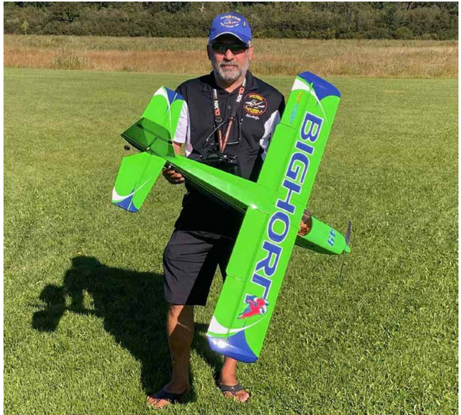
Mustafa Alemdag with his new OMP Bighorn, ready for maiden (which went well). Wingspan 1100mm, battery 2200 mAh 3s, all wood construction. / Mustafa Alemdag et son nouveau Bighorn (d'OMP), paré pour le vol inaugural (qui s'est bien déroulé). Envergure de 1 100 mm, batterie 3s de 2 200 mAh.
