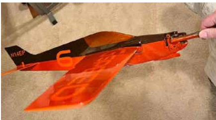
Finally, the Tangerine Metallic topcoat is applied. / Finalement, j'ai appliqué la couche finale de tangerine métallique.
