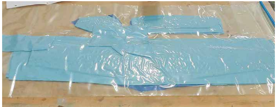
The wing cores in the vacuum bag setting up. / Le "coeur" des ailes dans le sac de mise à vide.
