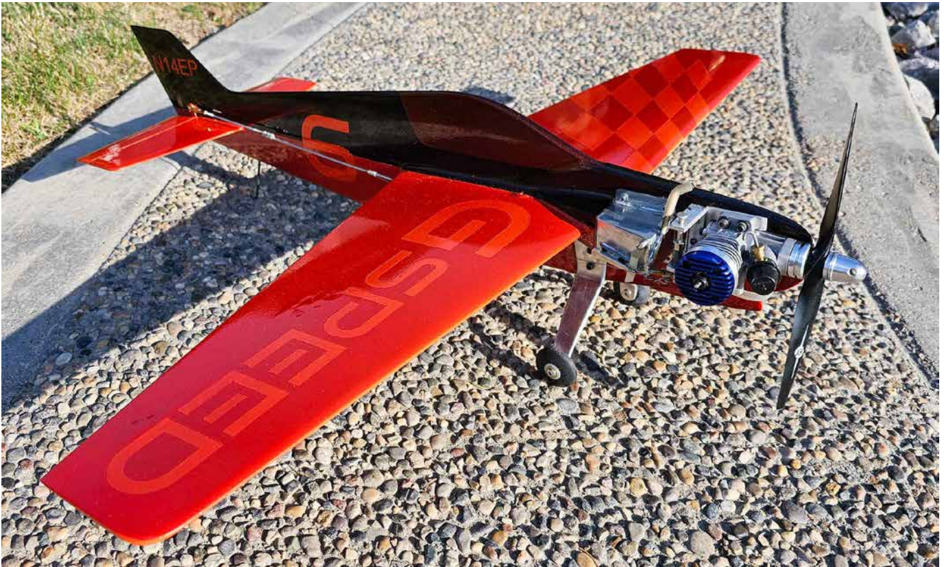
My Polecat Scale Racer built from a Pat King laser-cut kit, Bill Bischoff tank, shutoff & landing gear, Magnum .15 XLS for power. / Mon appareil de course Polecat, construit depuis un kit (de Pat King, découpé au laser) : réservoir, dispositif de coupe des gaz et train d'atterrissage de Bill Bischoff et moteur Magnum .15XLS.
