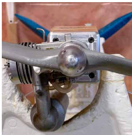
IA Jett 426 engine with original square back plate. Please note the standard engine rotation of 5 degrees down from level. / Le moteur IA Jett 426 muni de la plaque arrière carrée originale. Notez la rotation « standard » de 5 degrés du moteur (par rapport à l'horizontale).
